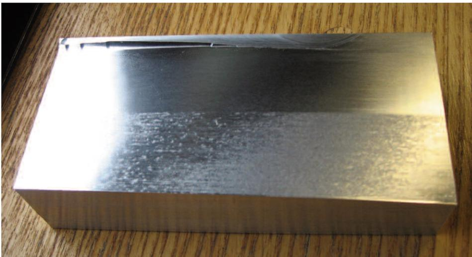
Abbildung 2: Gleichmäßig verteilte Punkte (obere Blockhälfte) ergeben eine bessere Oberflächengüte im Vergleich zu Punkten, die bei aneinander angrenzenden Schnittbewegungen verteilt werden (untere Blockhälfte).
